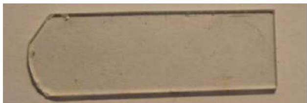
Fig3. 複数回使用した熱による損傷のないサンプル
