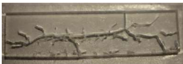
Fig1. 温度勾配により破損したサンプル例
